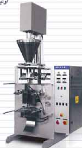
دستگاه بسته بندی عمودی پودری جهت بسته بندی مواد پودری از قبیل آرد، کاکائو، شیر خشک نمک، ادویجات، مواد شیمیایی و ...
