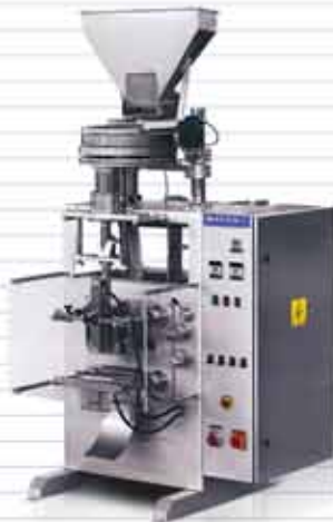
دستگاه بسته بندی حجمی جهت بسته بندی مواد گرانولی از قبیل تخمه، پسته برنج، حبوبات، پفک، پودر شوینده، شکر و ...
